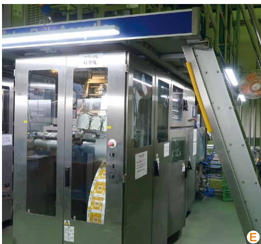
株式会社ふくれんの製造工場では、調合タンクで原材料を調合し(写真D)、異物除去、殺菌を経て充填機で充填し(E)、充填機から出てきた商品(F)に賞味期限を印字し、ストローを付けて箱詰めして出荷します。
